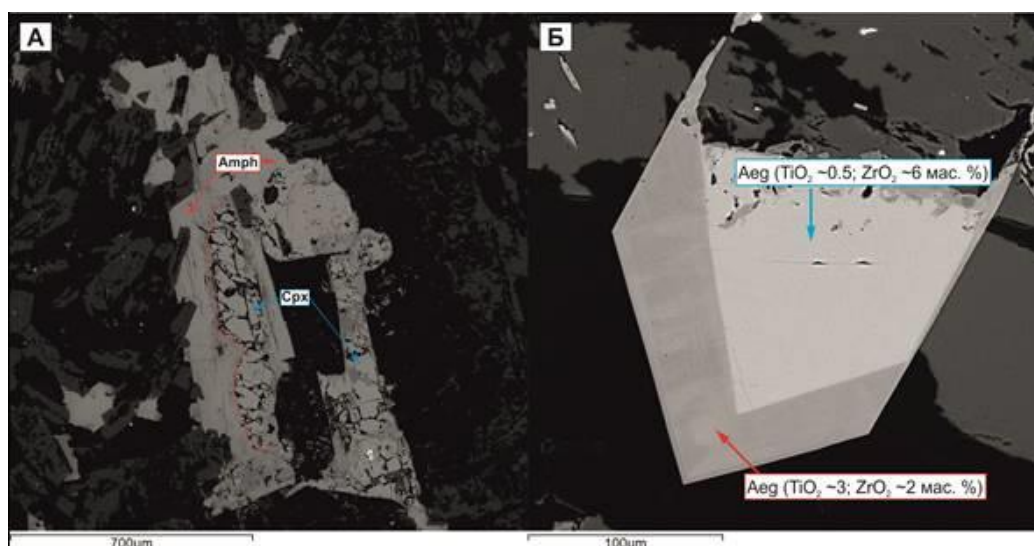
Рисунок 39 – Изображения в обратно рассеянных электронах реликтового клинопироксена (А) и единичного зерна эгирина (Б) в породах Цагаануульского дайкового пояса
