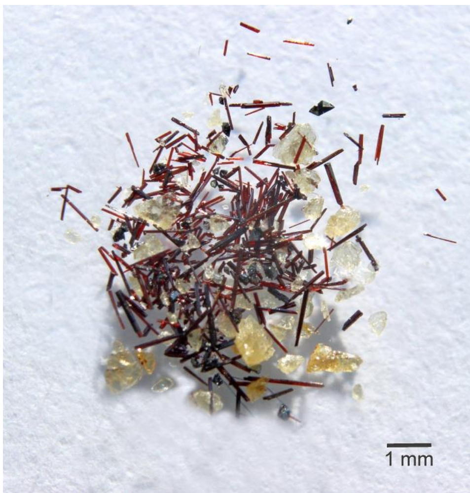
Рисунок 4 – Кристаллы РЗЭ-содержащих фаз (желтые - оксихлорид, красные – оксигидроксид), образующиеся совместно с гематитом (черные, изометричные) в гидротермальном эксперименте при 450 °С и давлении 1 кбар в 10%-ном \text{NH}_4\text{Cl}
