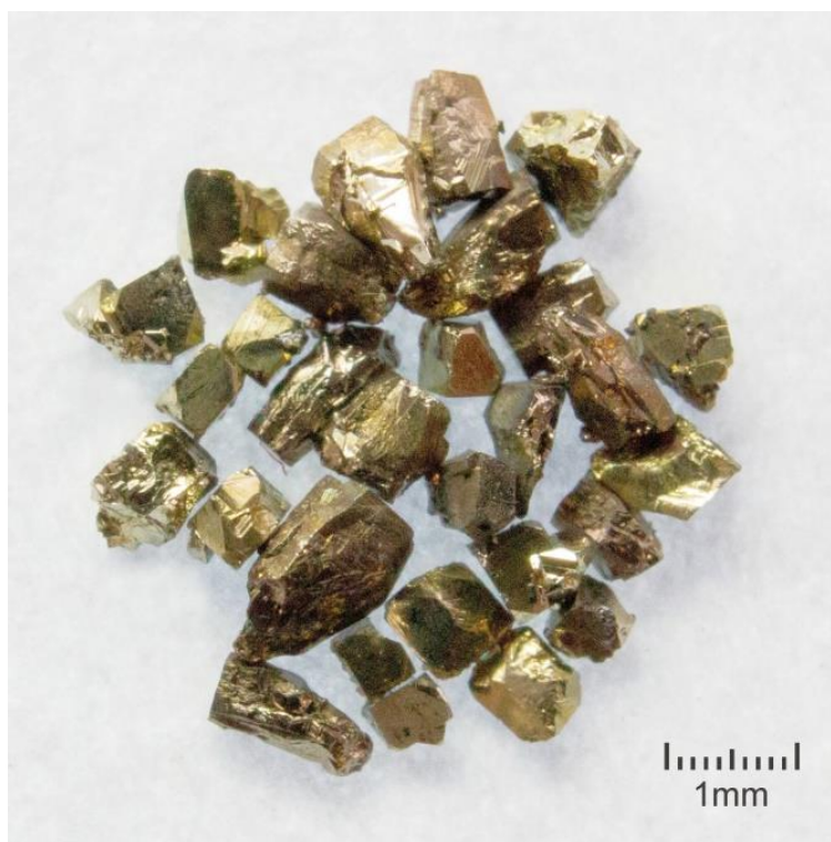
Рисунок 1 – Кристаллы ассоциации пирит-пирротин, полученные при 400 °С, давлении 1 кбар, в 10%-ном растворе NH_4Cl : преобладающие габитусные формы
