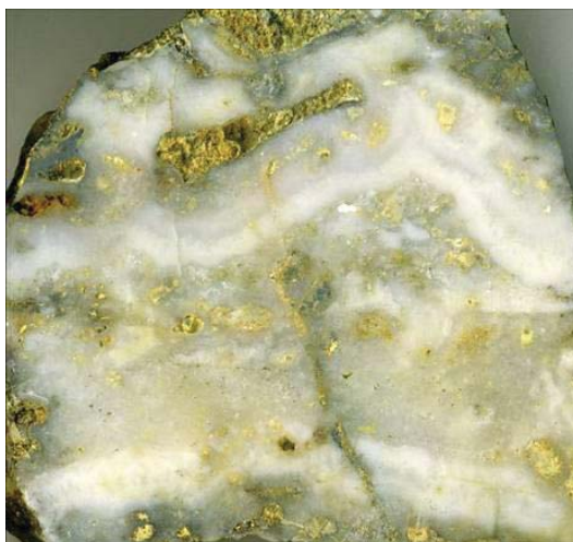
Рисунок 1 – Месторождение Дальнее. Адуляр-кварцевая жила колломорфно-полосчатой текстуры с самородным золотом и минералами Ag (карьер №1, гор. 443 м, жила № 1)
