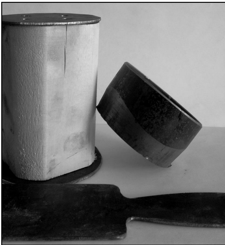
Рис. 2.4. Инструменты, необходимые для проведения полевых работ «методом кольца»
