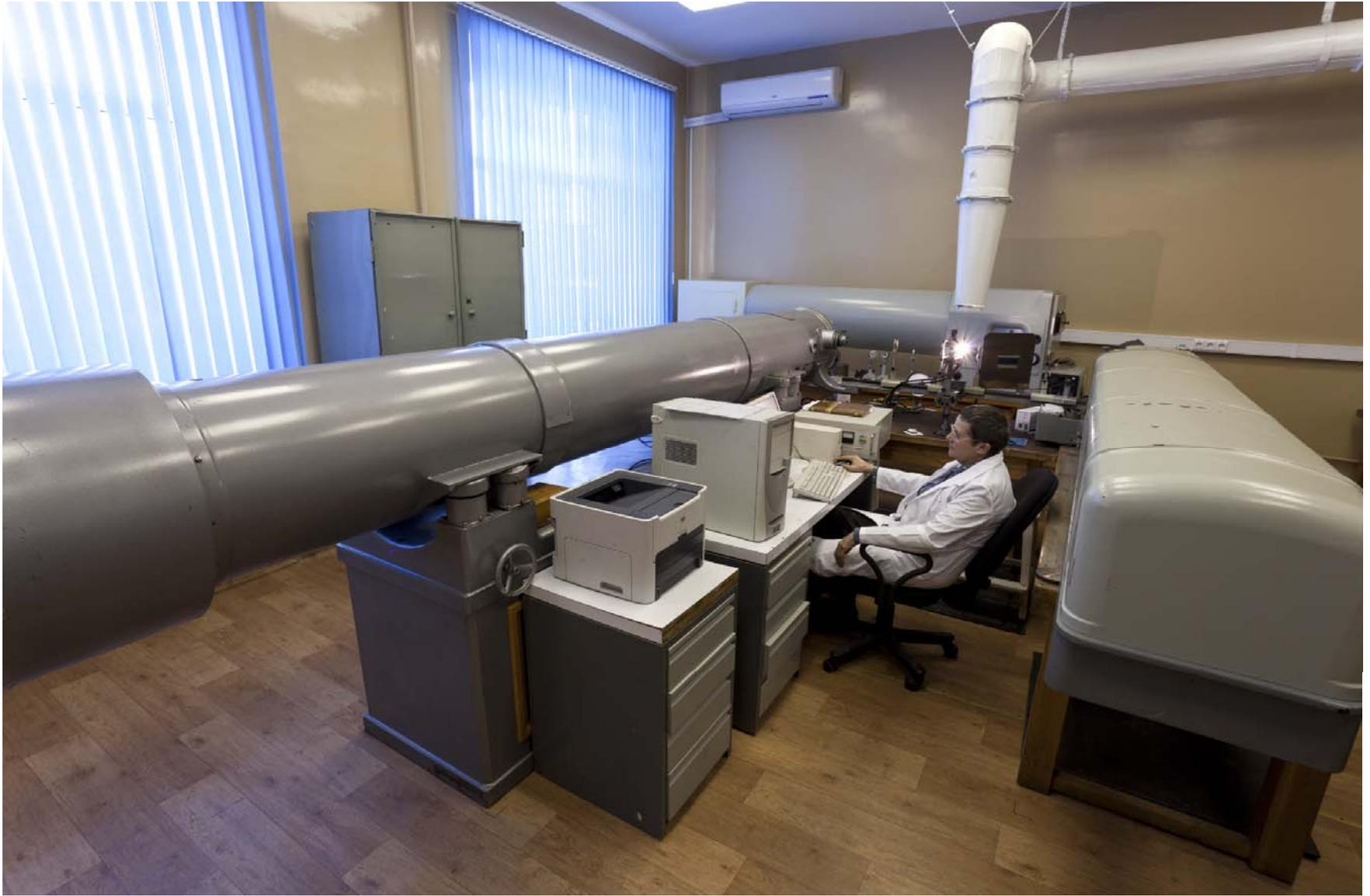
В кассетных частях спектрографов, там где ранее размещались фотопластинки, находятся регистрирующие блоки многоканального анализатора эмиссионных спектров - МАЭС.
