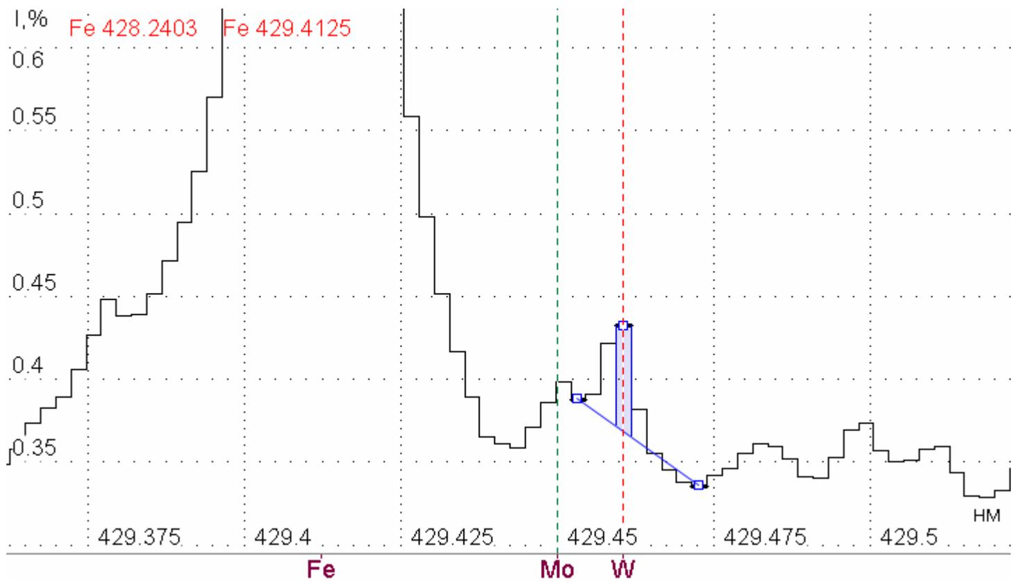
Показана область спектра аналитической линии вольфрама. Пик W I 429.461 нм на крыле линии Fe I 429.125 нм и мешающая линия Mo I 429.459 нм
