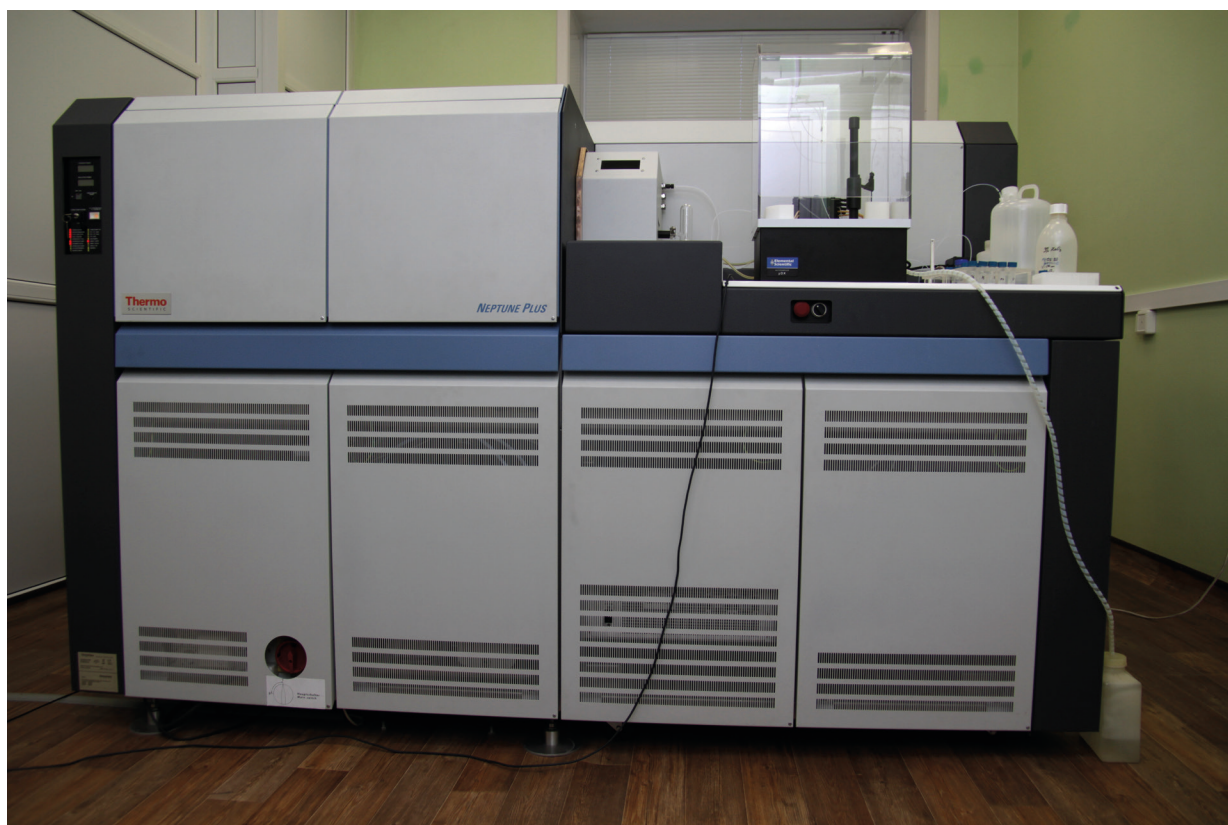
Рис. 7. Мультиколлекторный (MC-ICP-MS) масс-спектрометр Thermo Finnigan Neptune plus (ThermoFinnigan LLC, USA), оснащенный автосэмплером SC-Micro DX.
